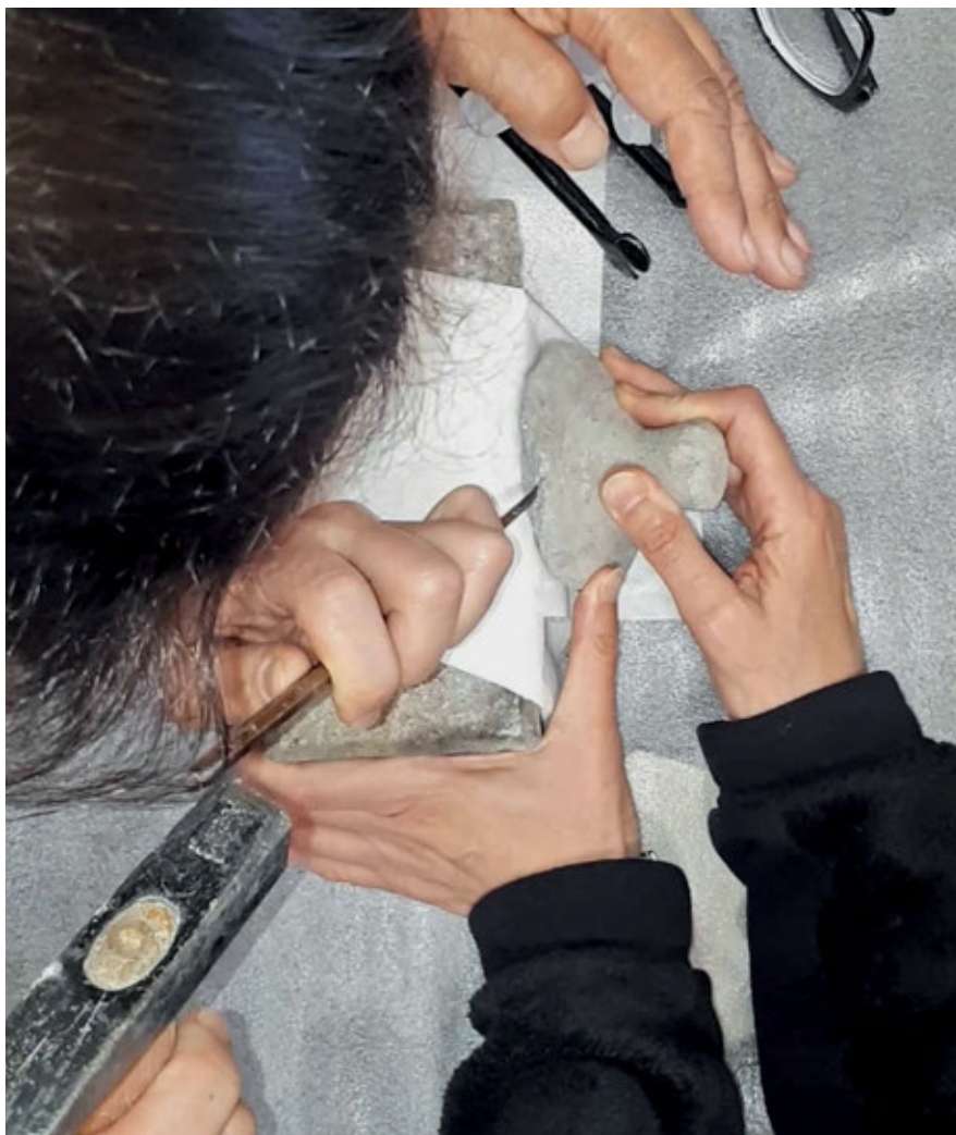
FIG. 2 – Prelievo di campione dal coperchio per l'indagine XRD (fotografia di Grazia Facchinetti. © SABAP-CO-LC).
