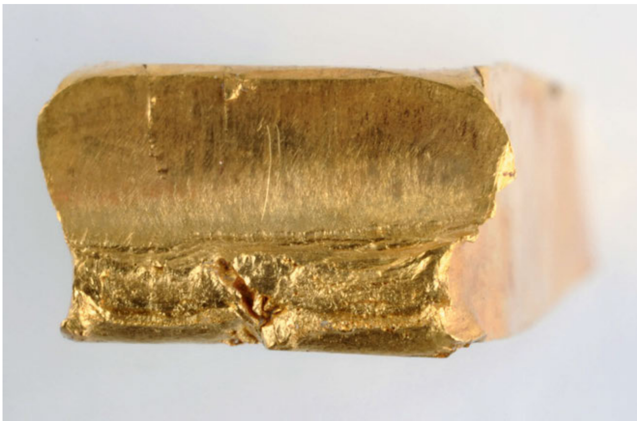
Fig. 17 – Frammento di lingotto in oro: estremità tagliata. La parte superiore è stata divisa facendo affondare una lama liscia, mentre la parte inferiore è stata staccata piegando il metallo fino alla rottura del reticolo cristallino. Si noti la bolla presente nella parte inferiore del lingotto, testimone della colata di oro fuso in uno stampo non adeguatamente riscaldato (fotografia di Luigi Monopoli. © SABAP-CO-LC).
