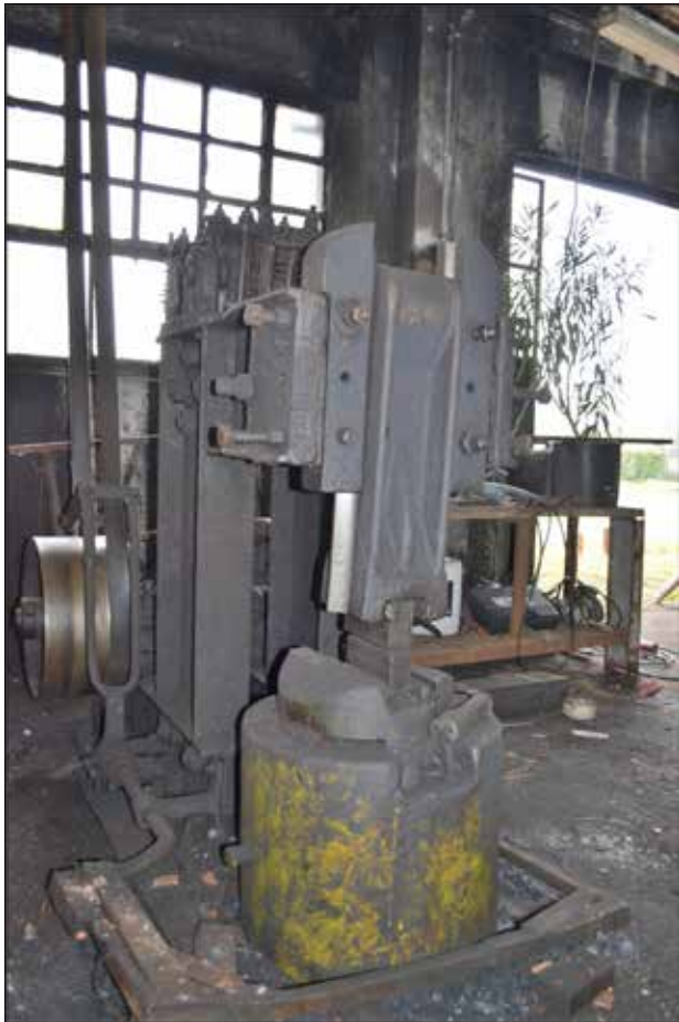
Fig. 57. Vista di fronte del maglio con le due spine di battuta e il sistema di leve per il comando a pedale dello spostamento della cinghia di trasmissione.
