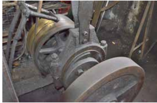
Fig. 56. L'eccentrico collegato con una biella al pacco delle balestre del maglio. Dalla parte sinistra si notano la puleggia folle e quella solidale all'albero dell'eccentrico. Azionando il pedale del maglio, un articolazione di leve sposta la cinghia dalla puleggia folle a quella fissa e viceversa.
