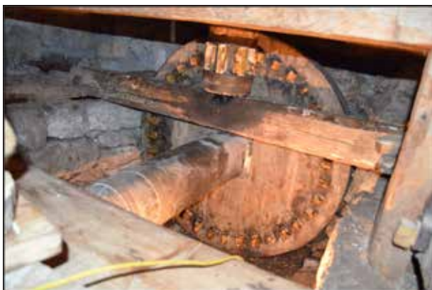
Fig. 12. Mulino di Campone (PN): La ruota dentata con denti in legno (lubecchio) che ingranano con quelli verticali della (lanterna) azionante la macina mobile.
