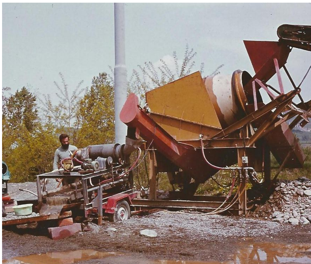
L'Autore nel 1980, con apparecchiature da lui ideate e utilizzate per le ricerche aurifere: sul carrello piccolo, trasportabile a rimorchio, è montata una canaletta vibrante con pompa, vaglio rotante e separatore magnetico a nastro, il tutto alimentabile con motore a scoppio
