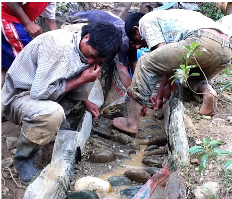
Recupero del concentrato in canaletta formata da fogli di plastica con ciottoli, in Perù (bacino del fiume Huallaga, presso Huanaco)
