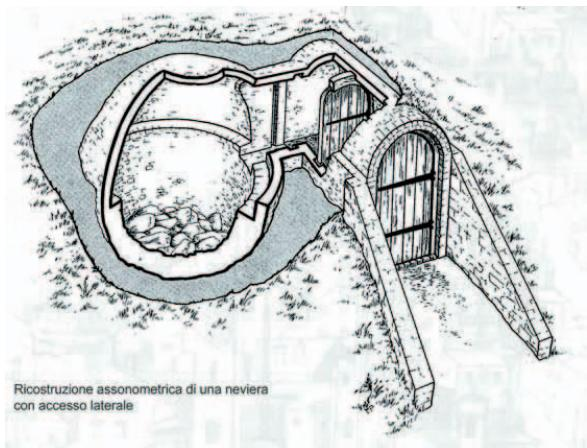
Ricognizione assonometrica di una neviera con accesso laterale
