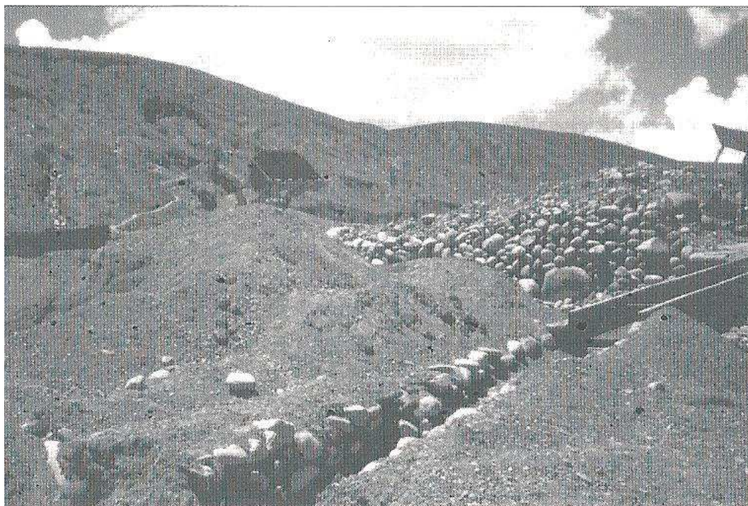
Canale predisposto nella discarica di lavaggio aurifero attuale, in Bolivia, con a monte il cumulo di ciottoli eliminati e ammassati a lato del canale di lavaggio (sluice box).
